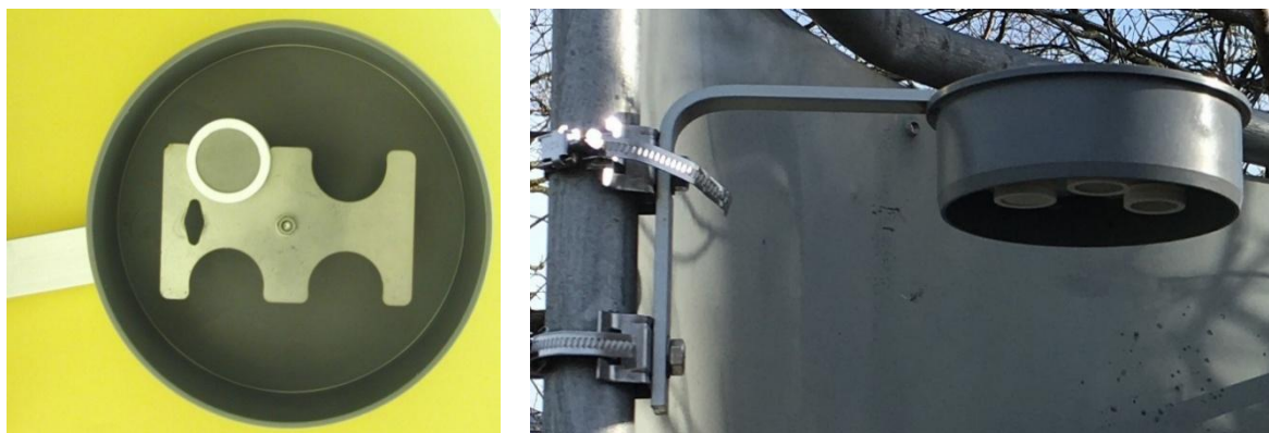
Abbildung 6: Ein Ferm-Passivsammler im Einsatz. 44 Pro Messpunkt werden immer mindestens zwei Messungen durchgeführt und gemittelt, um die Messgenauigkeit zu erhöhen.
