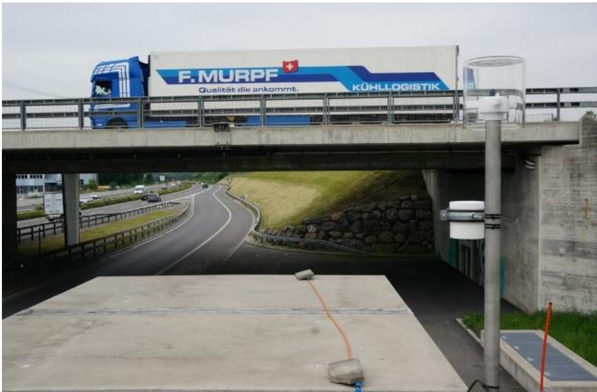
Abbildung 4: Messcontainer mit  $\text{NO}_2$ -Passivsammler.
