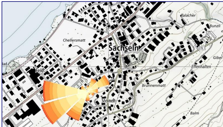
Abbildung 19: Schadstoffrose der Messungen in Sachseln 2019/20 auf der Landeskarte. Südwestlich der Messstelle befindet sich eine Holzschnitzelheizung. Deren negative Einfluss auf die Luftqualität kann nicht ausgeschlossen werden.
