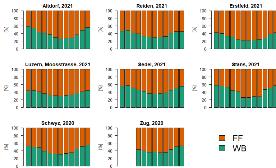
Abbildung 67: Ergebnisse aus dem Aethalometer-Modell: Relative Russwerte, aufgeteilt in die Quellen «ff» (fossil fuel), welche auf Verkehr hindeuten, und «wb» (wood burning), welche auf Holzheizungen hindeuten.
